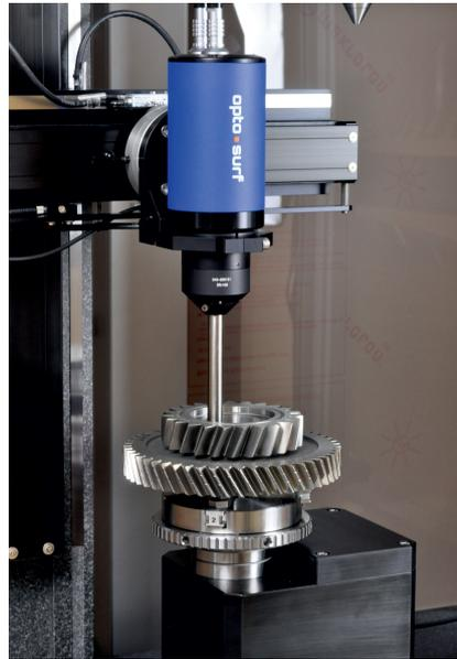
Bild 3. Mit dem System ist es möglich, vollflächige Lagesitze von Getriebewellen wie auch die Flanken von Schnecken und Spindeln zu messen.
